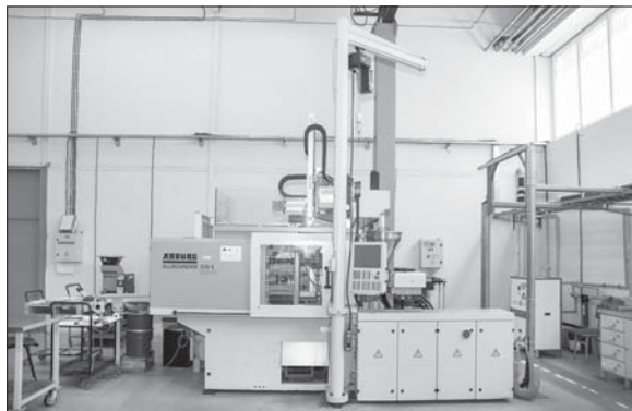
МІМ-инжекционно формоване, де-пластифициране и синтероване на метален прах
